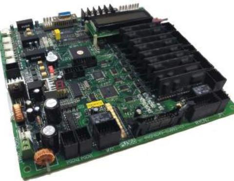
新一代堅尼西斯電梯，搭載由崇友研發團隊開發的新型驅動控制系統。採用多核心CPU架構，且對電源輸入、輸出波形全控制，能降低電網對系統的擾動，擁有高可靠度、穩定、順暢之特性。優化啟動控制、具主機啟動轉矩補償及高性能的電流、速度、位置環控制，可實現運行平穩，乘感提升的訴求。高速運行中，仍兼具低振動、低噪音的平穩表現，並提供更多貼心機能，使乘客搭乘更為舒適。
